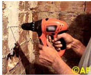
Taladro eléctrico de mano, que funciona con batería.
